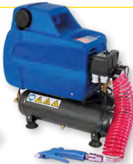
Ballkompressor ECU XSS228 Kompressor 230 V mit Druckbehälter, ölfrei, 2x3 Liter Druckbehälter mit Entlastungsventil, Manometer, 222l/min, Gewicht 20 kg, komplett mit 4 m Spiralschlauch, Pistole und Nadelventil. 03670 Stück 520.–
