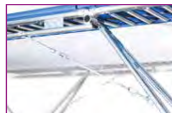
Kunststoffummantelte Stahlseile (leichter, verdrehsicher, geräuscharm beim Transport)
